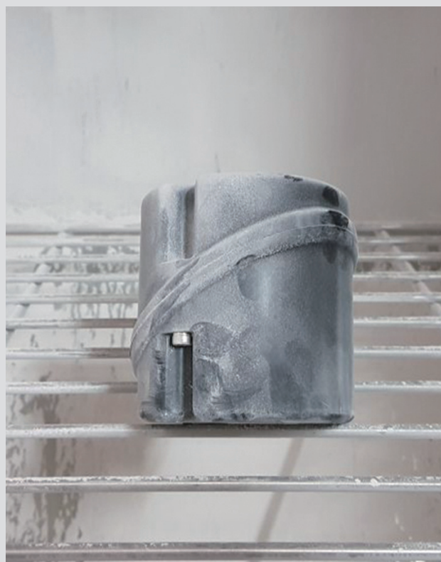
Alloggiamento durante il test IP6x
