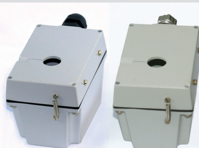
Dopo 1000 ore (fianco a fianco con un prodotto non sottoposto a UV)
