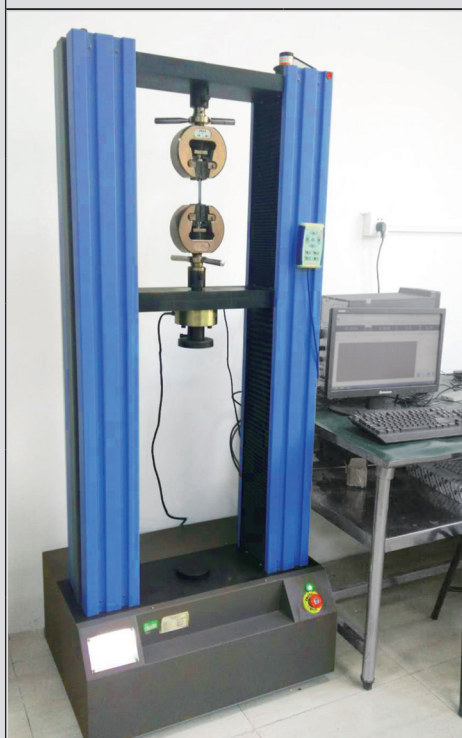
Apparecchiatura per la misurazione della resistenza alla rottura
