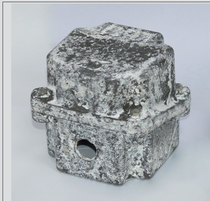
Superficie dopo il lavaggio con acqua saponata
