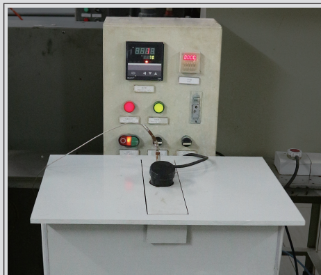
Bagno di test all'ipocloruro di sodio
