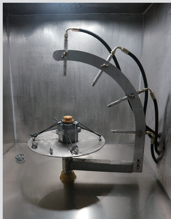
Alloggiamento durante il test IPx9k
