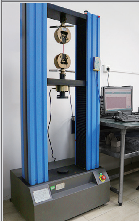
Banco di test di trazione
